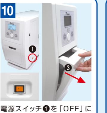
電源スイッチ①を「OFF」にし、前面カバー③を手前に引きます。
