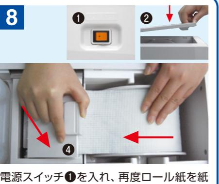
電源スイッチ①を入れ、再度ロール紙を紙送りカバー④内にセットし、上カバー②を閉じます。
