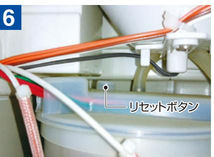
ヒータータンク上部のシリコンカバーの上から安全装置のボタンを押してリセットします。
